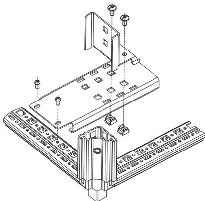
Установите гайки с фиксатором М6 в квадратные отверстия поперечных кронштейнов. Закрепите поперечные кронштейны на каркасе шкафа с помощью винтов резьбоформирующих М5х10. Установите монтажные кронштейны зацепами в пазы продольных кронштейнов и зафиксируйте их винтами М6х12. Для шкафов шириной 800 мм внутренняя группа отверстий для создания 19 дюймового монтажного пространства, последующие для создания 21 и 23 дюймового монтажного пространства.
