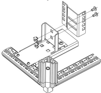
Установите гайки с фиксатором М6 в квадратные отверстия монтажных кронштейнов. Закрепите вертикальные направляющие с помощью винтов М6х12.
